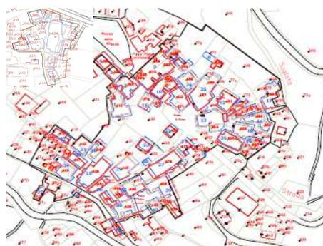
Figura 1-5 Overmapping tra CTR RA 1:5000 e Planimetria Catastale 1:2000
